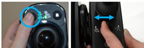
**Fig. 52** Commutez entre l'enfant et l'accompagnateur en pressant le bouton d'alimentation sur la commande accompagnateur (pour les LiNX, LiNX Plus ou DX) ou actionner l'interrupteur sur la commande accompagnateur (pour le Shark ou l'ancien modèle DX)
