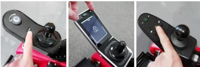
**Fig. 67 Pour déverrouiller le Wizzybug**
