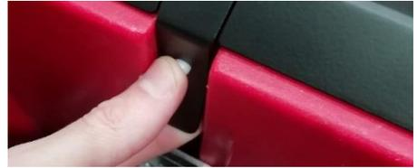
**3.** Pour déconnecter la batterie, faites glisser le curseur métallique sur le connecteur et en tournant le connecteur dans le sens inverse de l'aiguille d'une montre.
