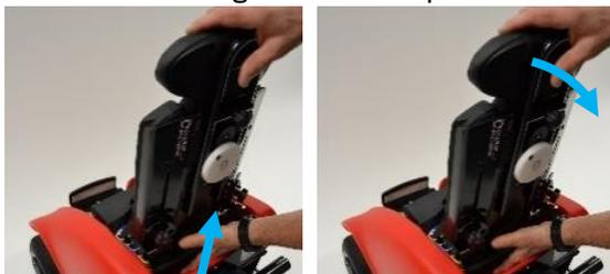
**Fig. 34 Réduire la profondeur du siège**
