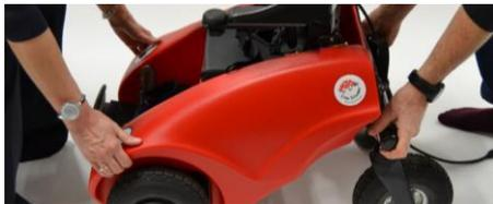
Pour **déplacer le Wizybug à la main**, faites glisser la languette métallique loin du point vert sur les deux roues. Pour **passer en mode conduite**, remettez la languette en position verte et poussez.
