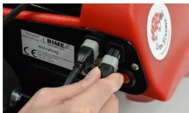
**Fig. 17 Câbles du joystick et de la commande accompagnateur**
