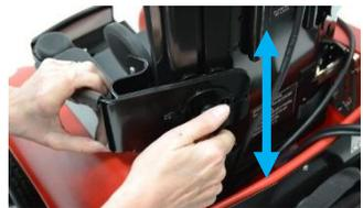
**Fig. 20 Réglage de la hauteur de l'accoudoir**
