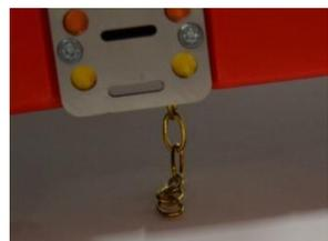
**Fig. 9** Chaîne antistatique
