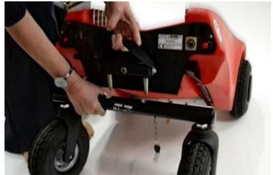
**Fig. 26 Retirer l'ensemble de roues arrières**
