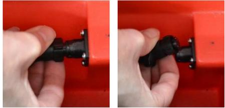
Fig. 24 Retirer la batterie SLA
